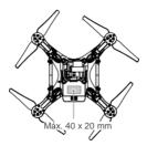
El compartimento de la batería en la parte inferior de la aeronave.
