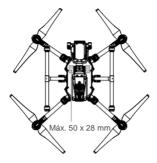
En los laterales del compartimento para la batería, cerca de la parte frontal, en la parte inferior del cuerpo de la aeronave. NO bloquee los altavoces que se encuentran cerca de esta posición.
