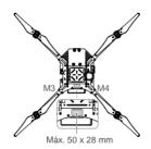
Centrada, al final de la placa superior (entre los brazos M3 y M4). Asegúrese de que la placa no obstaculiza ningún otro componente de la aeronave.
